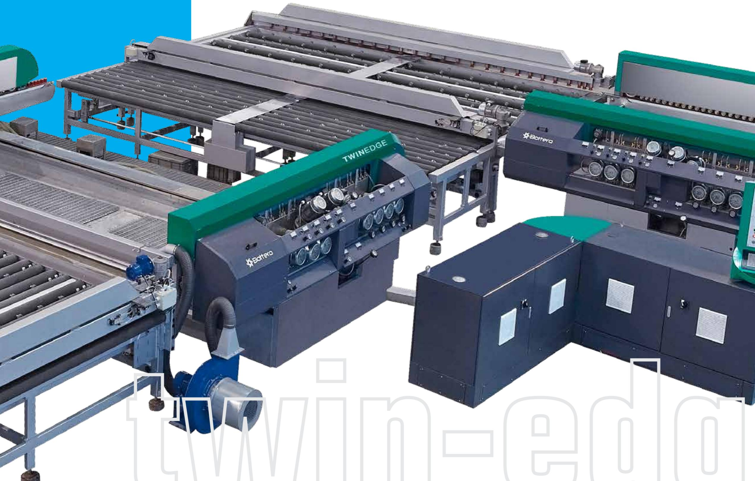
Twin-Edge è la gamma di bilaterali Bottero per la lavorazione del filo piatto. Le 4 configurazioni che la compongono, permettono la lavorazione del filo piatto, dei filetti ed eventualmente la rimozione dello spigolo.
